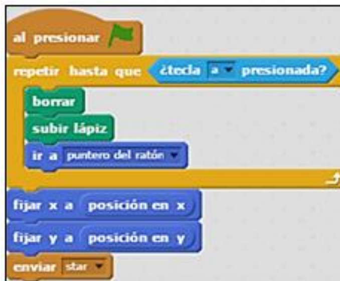
Figura 3. Programación de segunda ley de Kepler en el prototipo realizado en Scratch
