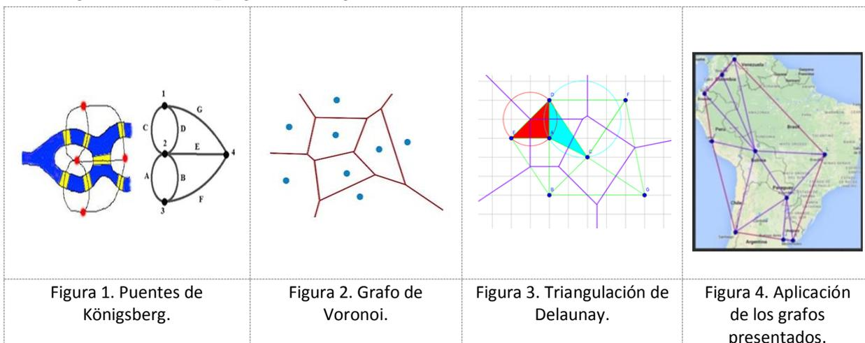
El grafo de Voronoi viene a ser un elemento de la teoría de grafos y está a disposición en el estudio de geometría computacional. Un grafo de Voronoi se define de la siguiente manera: “*Dado un conjunto de vértices  $V$  en el plano, el diagrama de Voronoi de  $V$ , es una descomposición en el plano en regiones relacionadas a cada uno de los  $V$* ” (Moreno & Ordóñez; 2009).
