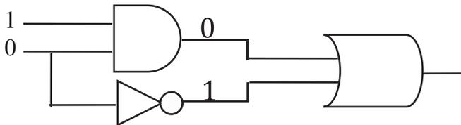
Observando este último circuito (Figura 8), puede notarse que en las entradas del circuito OR se encuentra 1 y 0 lo que significa, de acuerdo a lo visto anteriormente, que el circuito se encuentra encendido, ya que al menos una de las entradas presenta un 1. El circuito queda de la siguiente manera:
