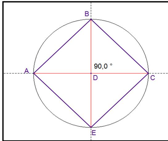
Figura 9. Construcción geométrica para la  $crd(90^\circ)$
