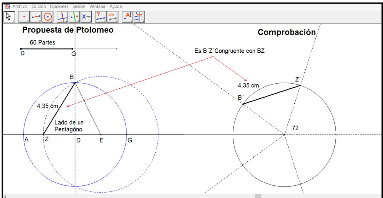
Figura 7. Comprobación de construcción de Ptolomeo para la  $crd(72^\circ)$  y el valor del lado de un pentágono regular.
