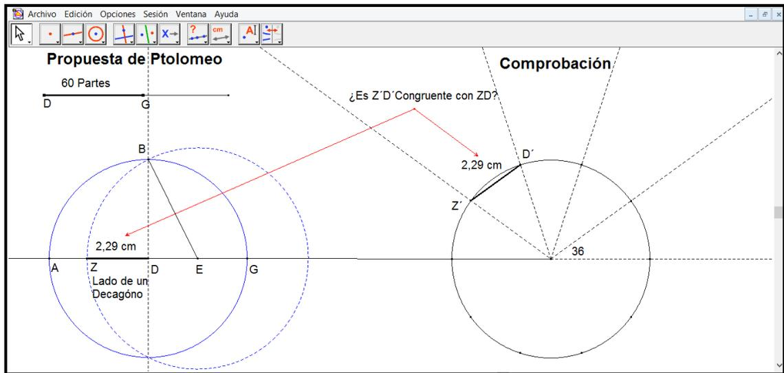
Figura 6. Comprobación de construcción de Ptolomeo para la  $crd(36^\circ)$  y el valor del lado de un decágono regular.
