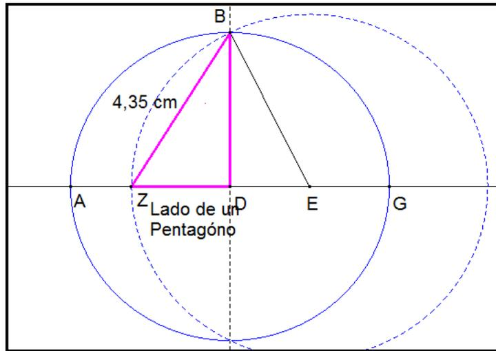
Figura 8. Construcción geométrica para la  $crd(72^\circ)$ .
