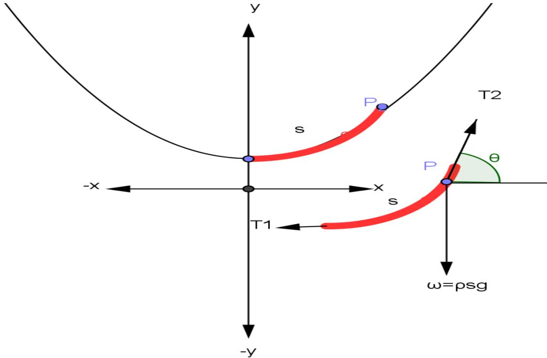
Ilustración 28: Diagrama de fuerzas en la catenaria
