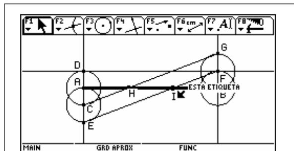
Luego en F se traza circunferencia con radio FB y se busca punto de intersección G. Unimos G con C y se obtiene H. Unimos F con E y se obtiene I.
