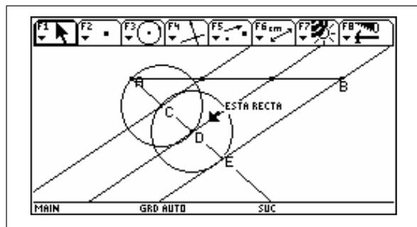
También aprovechando la opción SIMETRÍA se puede realizar ubicando el punto C, arbitrario, sobre la semirrecta que se traza por A. Se busca la imagen de A con respecto a C y da D, y de C con respecto a D para obtener E. Se une E con B y mediante la opción paralela se trazan por D y C paralelas que dan los puntos de corte sobre el segmento (F y G)
