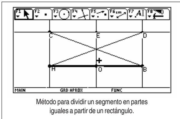
Para dividir un segmento en dos partes iguales: Se traza un segmento AB. Por A y B se trazan perpendiculares al segmento. Se ubica C arbitrariamente. Por C se traza una paralela al segmento AB y se busca el punto D. Se calcula el punto medio de las diagonales AD y BC y por este punto se traza una perpendicular a AB y se etiqueta con O.  $AO = OB$
