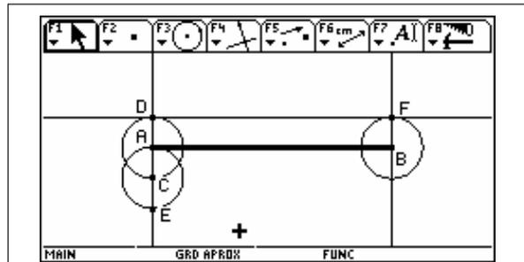
Se traza segmento AB. En A perpendicular al segmento AB. Por B se traza paralela a la perpendicular. Se ubica C arbitrario. Se traza circunferencia en A con radio AC y se buscan punto de intersección D. En C se traza circunferencia con radio CA para buscar E. Por D se traza paralela a AB y se busca F.
