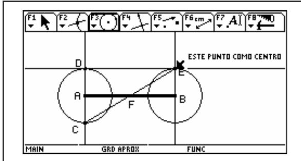
A partir de la opción simetría del software CABRĪ, se trabajó así: Segmento AB; perpendicular por A; ubicar arbitrariamente C y buscar simetría de C con respecto a A para encontrar D; paralela a AB por D para buscar E. Unir C y D para encontrar F. Se determina por medidas que  $AF = FB$ .
