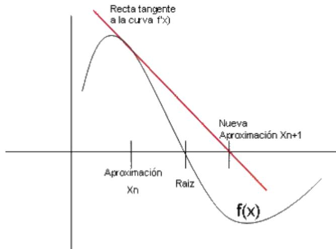
Figura 5. Método de Newton explicación gráfica.
