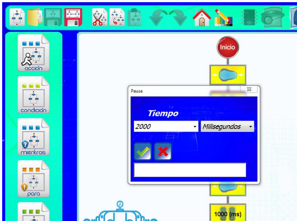
Gráfica 14 Variable icónica de pausa (tiempo de duración de la última acción)
