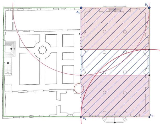
Figura 3. obtención de los dos rectángulos recíprocos y comprobación de que el complementario es un cuadrado
