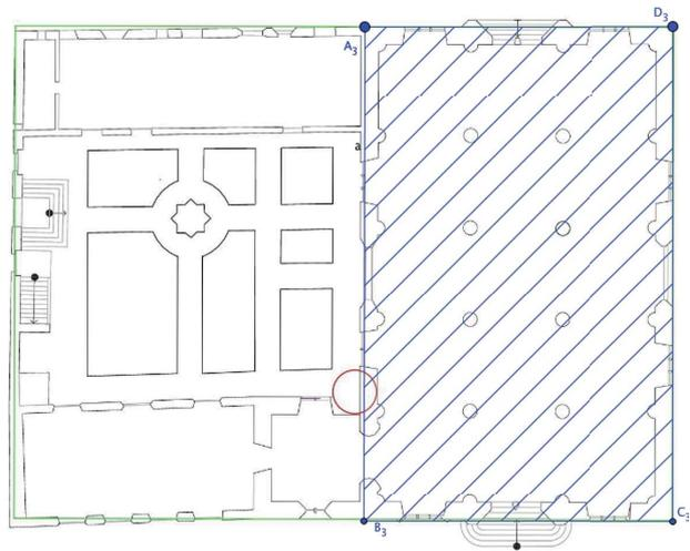
Figura 2. Planta de la Lonja de la Seda de Valencia en la que se observa que el salón Columnario es un rectángulo áureo
