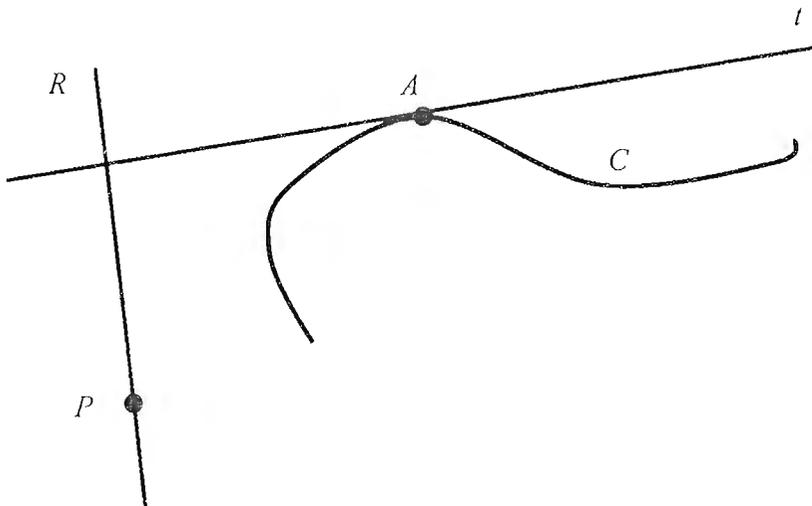
Tomemos una curva  $C$  cualquiera y un punto  $P$  en el plano. Por un punto  $A$  de la curva trazamos la tangente ( $t$ ) correspondiente a la misma, y desde  $P$  trazamos la perpendicular a la recta  $t$ . La curva pedal asociada a la curva  $C$  y al punto  $P$  es aquella descrita por el
