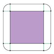
Se ve que en este caso la elevación de la cinta no requiere un largo adicional, excepto lo que se añadiría en las cuatro esquinas, que completan una circunferencia de radio 2 (altura de los pilotes) y que no depende del valor del lado del cuadrado. Si en lugar de un cuadrado, consideramos un octógono, la situación sería:
