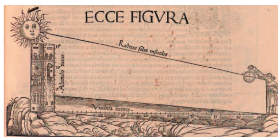
Figura 6. Imagen de la técnica de medición cuando la elevación del Sol es menor a 45°, tomada de “ Elucidatio Fabricae Ususque Astrolabii ”, por Stöffler, 1513, segunda parte, folio LXXI
