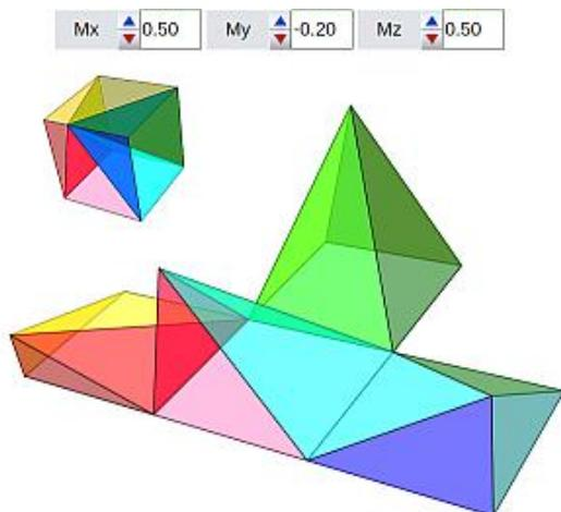
Figura 2. Punto ubicado en una arista, descomposición en cuatro pirámides.
