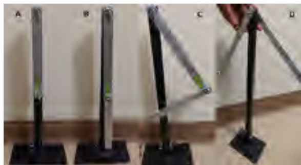
Figura 1. A) péndulo simple, B) péndulo doble en reposo, C) articulación del péndulo doble
