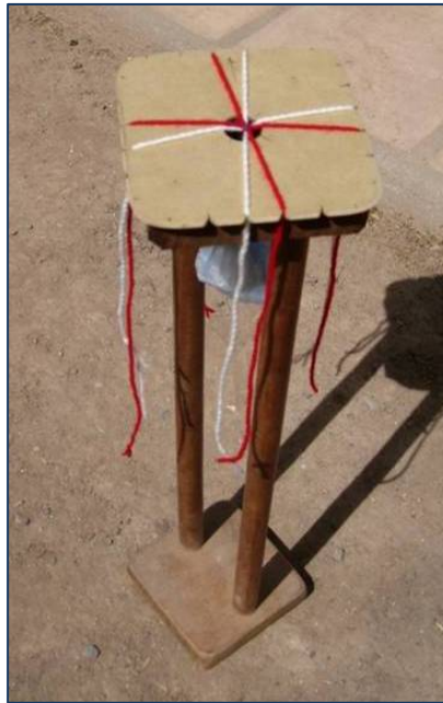
Figura 1. Telar de madera llamado “carta”, para la realización de las trenzas. En el caso mostrado en la foto se trata de una trenza de 8 hilos.
