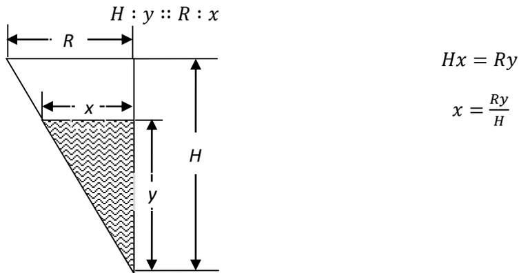
Fig. 3 Sección del depósito con dimensiones  $x$ ,  $y$ .
