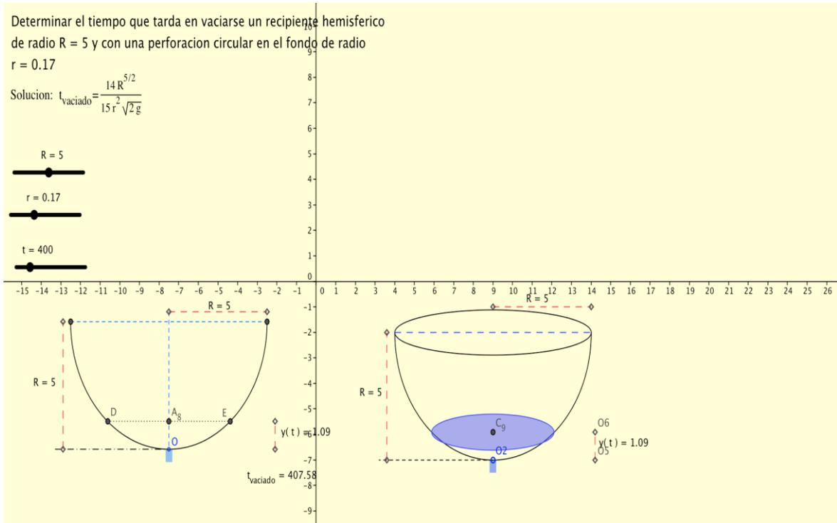
Fig. 7 Fase terminal del vaciado de recipiente
