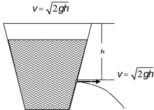
Fig. 1 Recipiente perforado a una distancia  $h$  del borde
