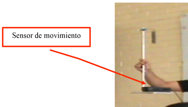
Figura 9. Ubicación del punto de referencia del sensor en el sistema físico del resorte
