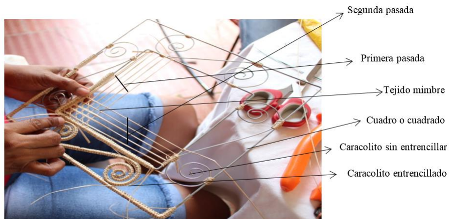
Figura 3. El paso a paso de la construcción de un individual. Fuente: Fotografía de los autores, trabajo de campo.
