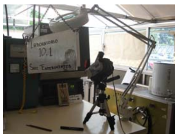
Figura 3. Experimento temperatura de Curie para cerámica de bismuto
