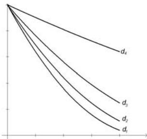
Dado a que el diámetro del depósito se mantendrá constante el diámetro del orificio será el que se variará, esto permitirá ver que ente mayor sea la diferencia entre estos el flujo másico del permanecerá constante.
