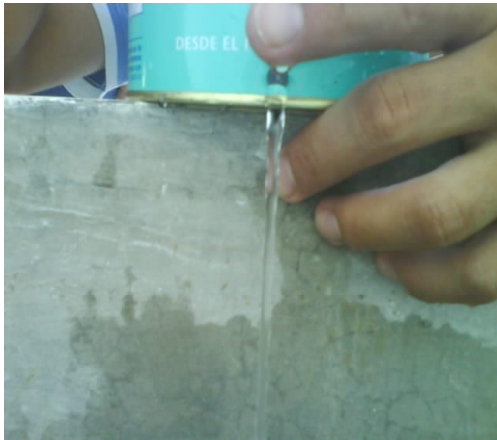
Poca presión del agua debido a la altura de la misma dentro del recipiente.
