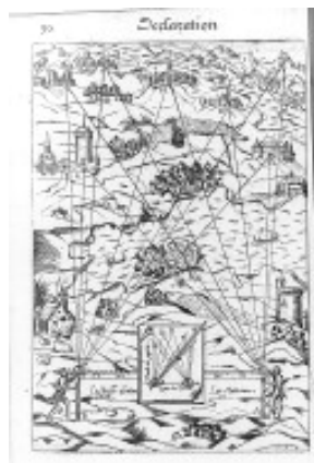
Figura 5. Técnica de medición angular y lineal mediante intersecciones, haciendo uso del grafómetro, sugerido por Danfrie (1597).
