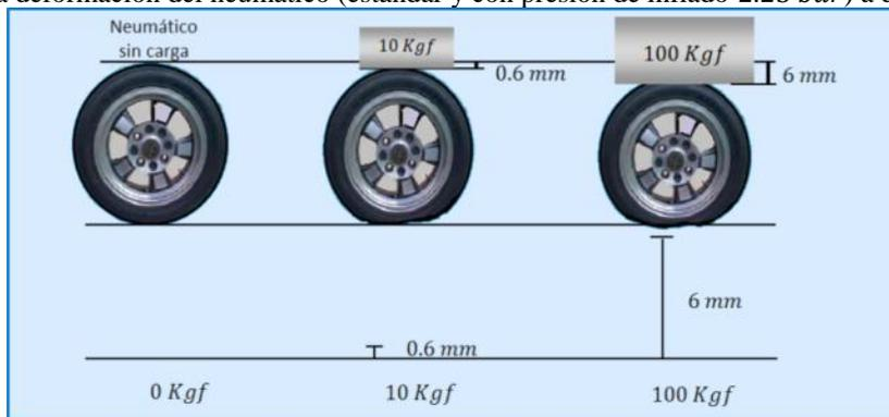
A. Determina la cantidad de deformación del neumático al aplicarle una carga de 200 kgf.
