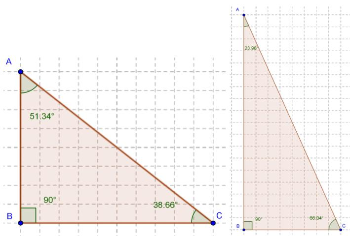
Figura 8. Triángulos rectángulos contruidos para aproximar los ángulos centrales de heptágono ( $51,34^\circ$ ) y pentadecágono ( $23,96^\circ$ ).
