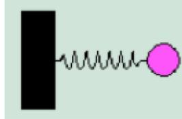
Supongamos que la reacción del sistema al desplazamiento  $\Delta x$  desde la posición de equilibrio puede modelarse mediante la ley de Hooke:  $F_{\Delta x} = -k\Delta x$  en donde  $k$  es una constante que depende de las características físicas del resorte.
