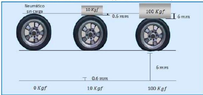
Imagen 1. Pruebas de la deformación del neumático a distintas cargas (Neumático con dimensión estándar y presión de inflado 2.25 bar)
