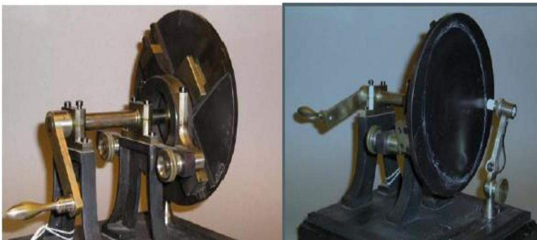
Figura 3. Modelo del trasmallo de la colección cinemática de Reuleaux (Foto del profesor D.W. Henderson)
