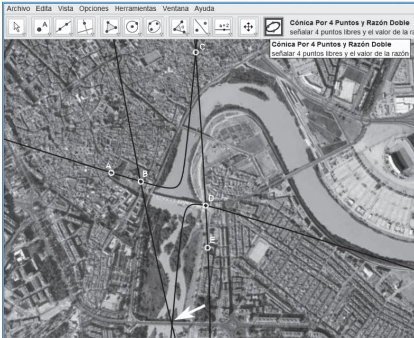
Figura 11. Trazado de las cónicas correspondientes. En el punto de intersección, señalado por la flecha blanca inferior, estaba el fotógrafo.
