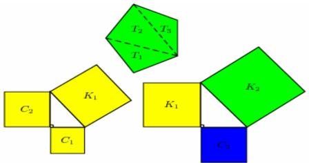
Una aplicación del Teorema de Pitágoras nos da un cuadrado  $K_1$  de área  $c_1^2 + c_2^2$  y la siguiente el cuadrado  $K_2$  de área  $c_1^2 + c_2^2 + c_3^2$  según la figura.
