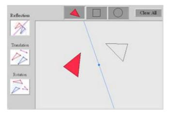
El programa permite mover la figura inicial (roja) arrastrándola o aproximando el puntero a sus vértices, y ver el resultado en su transformada. También se puede trasladar y girar el eje en el caso de la simetría, el vector en el caso de la traslación, y el centro del giro y su amplitud en el caso de las rotaciones.
