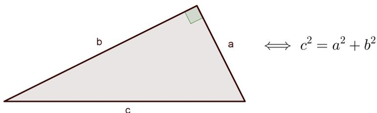
Figura 1. Ilustración gráfica del enunciado del teorema de Pitágoras
