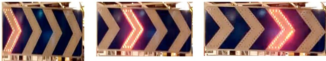
Figura 2: Movimiento de una luz en una baliza de dirección
