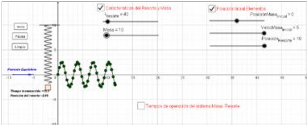
Figura 4. Visualización gráfica, en la simulación, para el movimiento del sistema masa resorte bajo las condiciones planteadas en la Actividad 2 con GeoGebra.
