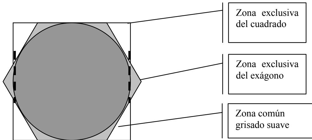
Con lo cual el problema se reduce a determinar la cantidad de lugar desperdiciado que en base al esquema podemos resumirla en los cuatro triángulos blancos (para el cuadrado) y los dos triángulos grisados que sobresalen del cuadrado (para el exágono)
