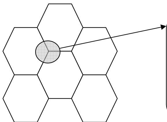
Los ángulos interiores de un exágono regular son de  $120^\circ$ , por lo tanto al converger 3 de ellos en un vértice el resultado es de  $120^\circ$ .  $3 = 360^\circ$ , lo cual asegura el cubrimiento completo.
