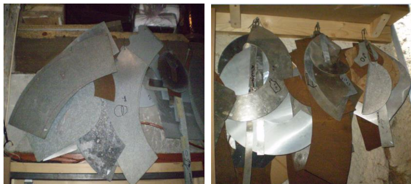
Figura 15. Exemplos de moldes usados na latoaria
