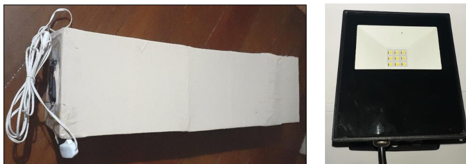
Figura 7 – Kit de projeção com caixa para diminuir a dispersão da luz e refletor.
