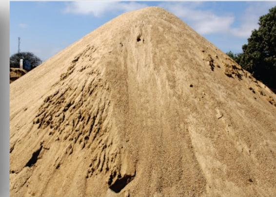
El material granulado permanece apilado y no se desliza debido a una cierta fricción entre las partículas. El ángulo de inclinación del montículo (ángulo formado entre el copete y la horizontal) se denomina ángulo de reposo y es el ángulo máximo que permite que el material granulado se mantenga sin deslizarse o resbalar (ver la figura).
