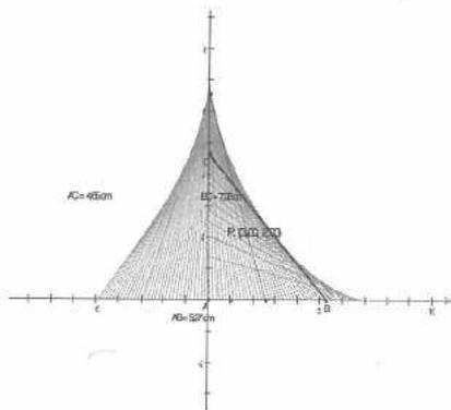
Figura 17. Lugar geométrico del segmento fijo (hipotenusa) cuando un extremo se mueve sobre el eje X
