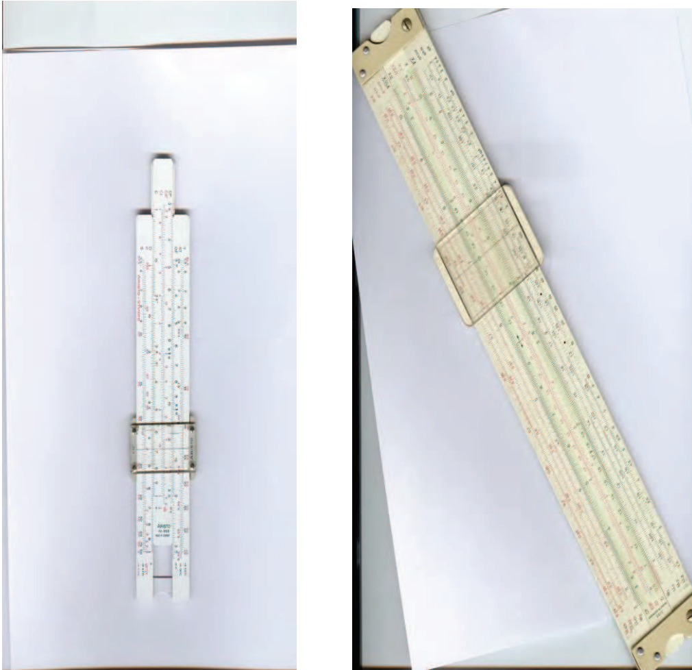
Figuras 1. Fotografías de las Reglas de Cálculo de Bolsillo y de Escritorio
