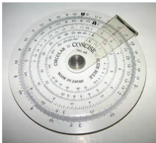
Figuras 2. Fotografía de la Regla de Cálculo Circular
