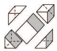
Destazamiento por dos planos que cortan al hexaedro en las diagonales de la cara superior e inferior. Forma cuatro prismas triangulares.
