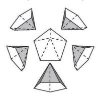
El icosaedro y su destazamiento por medio de dos planos que cortan a cinco triángulos que se unen en un mismo vértice. Forma dos pirámides con base pentagonal y un antiprisma con base pentagonal (en lugar de rectángulos son triángulos equiláteros y las bases son pentágonos con un desfase en cada vértice).
