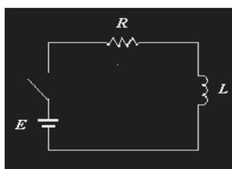
Figura No2. Representación gráfica de un circuito eléctrico RL.
