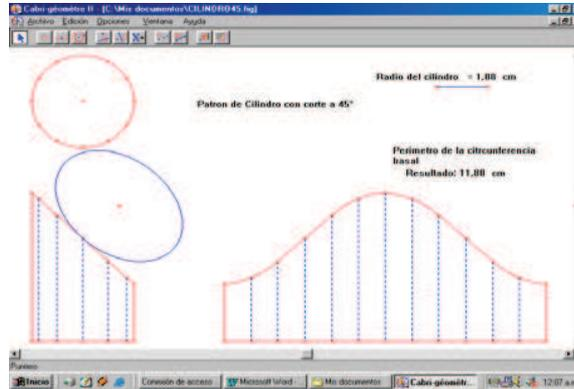
Red para construir un cilindro con corte a  $45^\circ$
