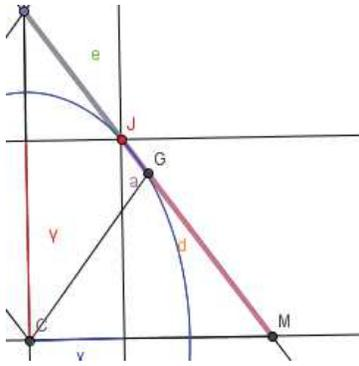
Siendo  $J$  el punto de traza, el elipsógrafo de Von Schooten permite que con el movimiento de la recta  $GM$  por los ejes ortogonales se pueda pensar en la elipse como el lugar geométrico de  $J$  que dicho movimiento produce.
