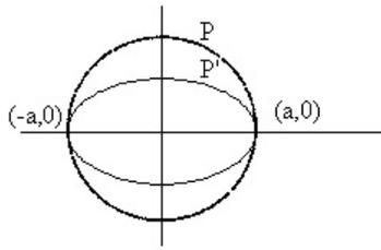
El punto  $P$  de la circunferencia se transforma en el punto  $P'$  de la elipse, después de la contracción. Las coordenadas de  $P'$  son  $(x, y)$  y las de  $P : (x, \frac{y}{\lambda})$ . El radio del círculo coincide con  $a$ .
