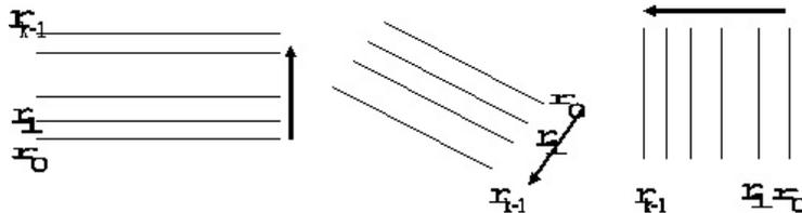
Si definimos un sentido perpendicular al  $k$ -haz (en la ilustración anterior indicado con la flecha) tendremos un **haz paralelo ordenado**. Las rectas se enumeran:  $r_0, r_1, r_2, \dots, r_{k-1}$ ; en forma prelativa y en el sentido dado. Las rectas  $r_0$  y  $r_{k-1}$  se denominan extremos del  $k$ -haz.
