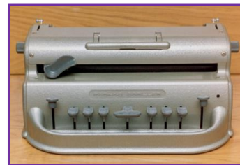
Imagen 17. Máquina de Perkins Nota Tomado de Nela. Un entrenador de Braille para niños (Sánchez, 2013, p. 52)
