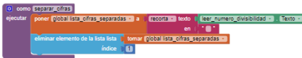
Ilustración 7: Bloques para recortar las cifras del número ingresado y hacer una lista con estas
