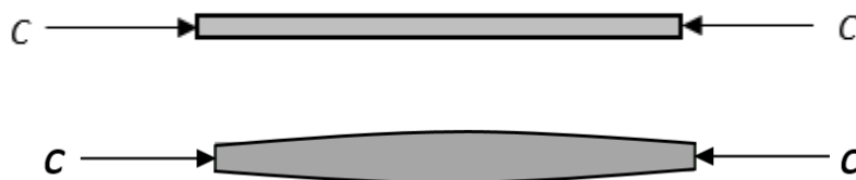
Figura 1.1.3: Viga bajo compresión.
