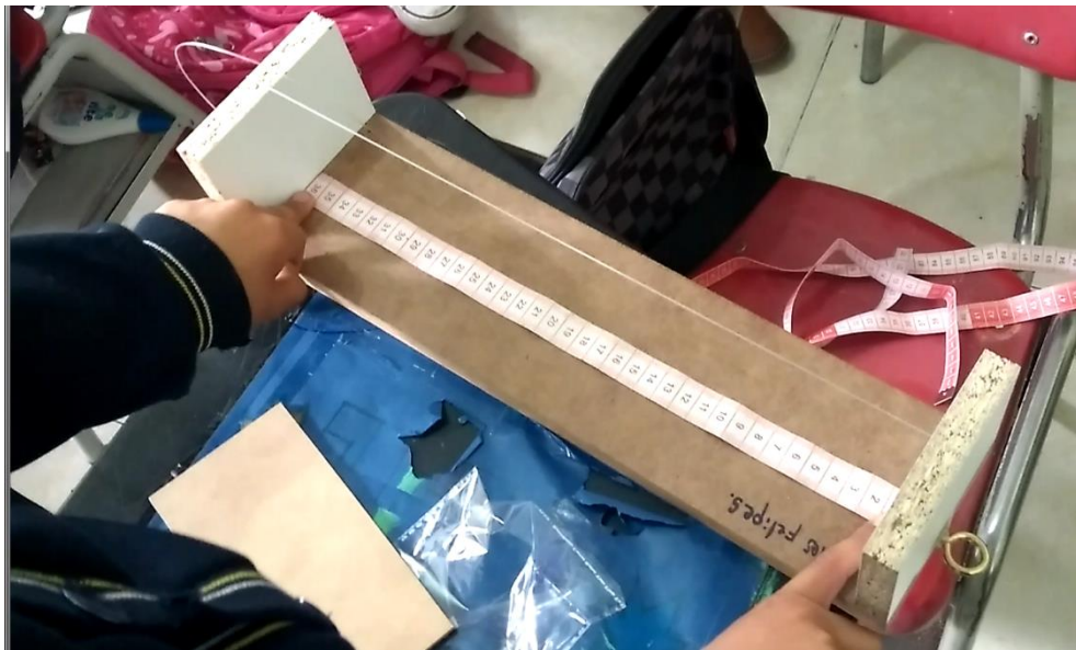
Ilustración 9 Construcción del monocordio, metro guía.
