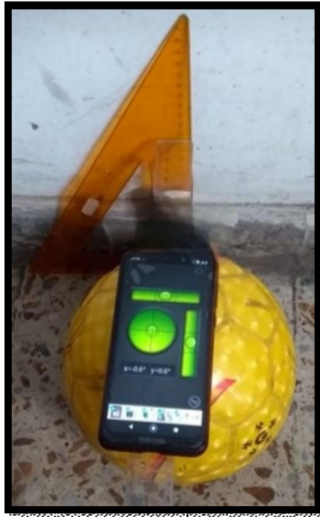
Figura 12. Uso del nivel para validar horizontalidad de la regla no graduada
