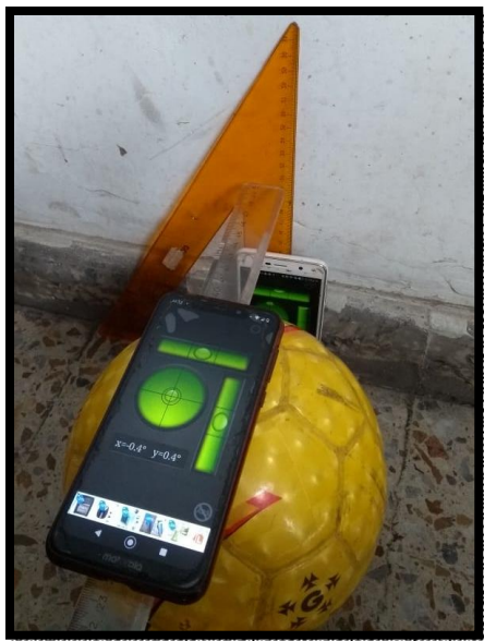
Figura 13. Uso de la aplicación de los dos niveles para garantizar horizontalidad y perpendicularidad de las reglas
