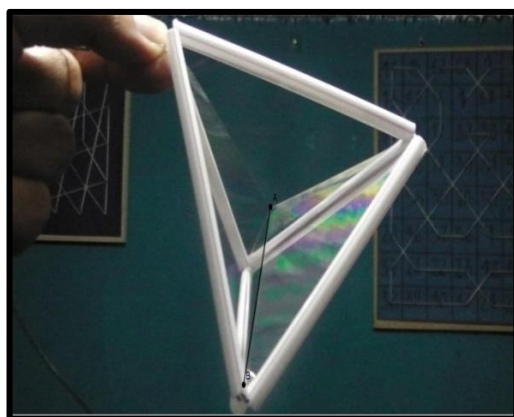
Ilustración 24: Pompa de jabón en un bastidor tetraédrico
